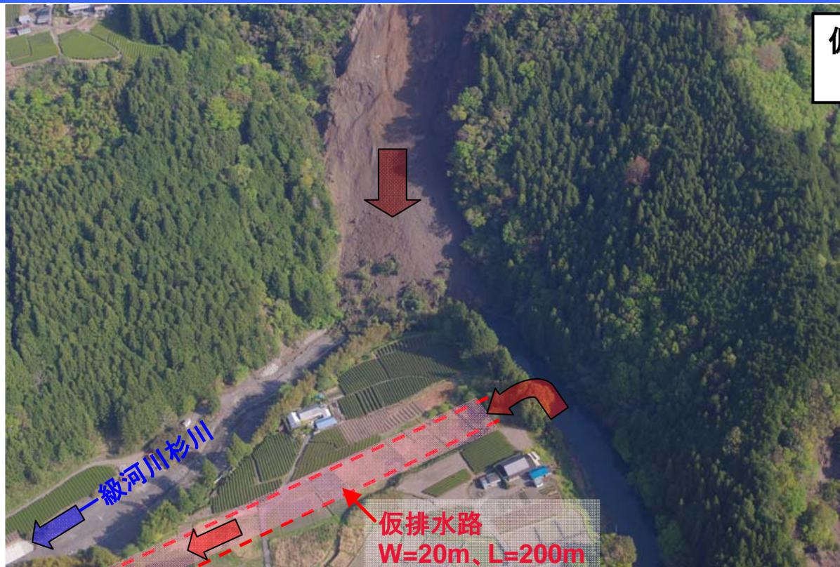
仮排水路工完成(幅20m、長さ200m)
