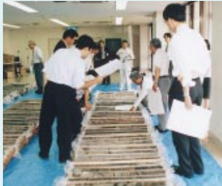
ボーリングコア調査
