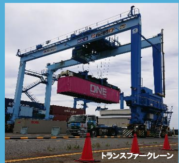
トランスファークレーン
