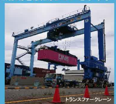
トランスファークレーン
