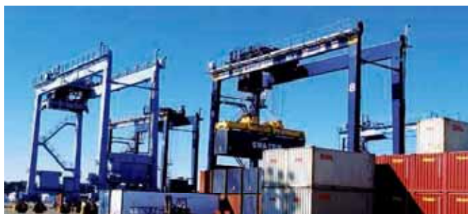
コンテナ蔵置レーン(トランスファークレーン) [Container Storage Lane(Transfer Crane)]
