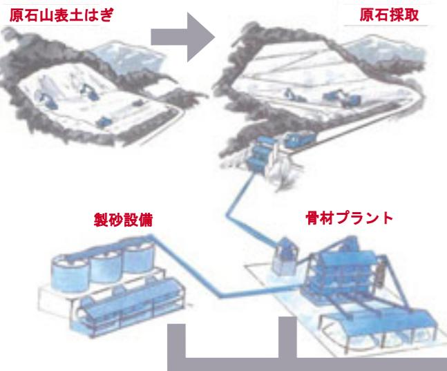
ダムのコンクリートは、セメントと水、骨材（岩石や砂）を配合して造られます。
