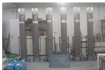
沈降試験の状況 (他ダムでの事例)
