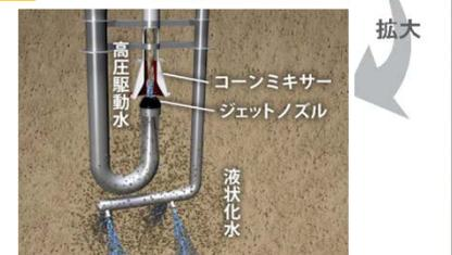
液状化水（青色）を海底面に吐き出して、堆積した土砂を纏めて舞い上がらせ、高圧駆動水（白色）と一緒にスラリー（赤色）として吸い上げます。
