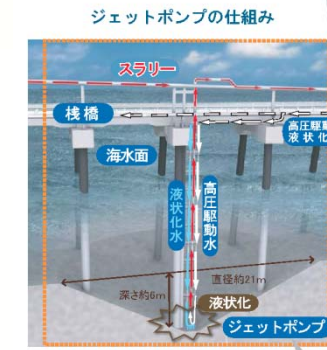
栈橋は、福田漁港西防波堤から沖に向かって設置されています。栈橋にはジェットポンプを取り付け、海底から土砂を採取します。
