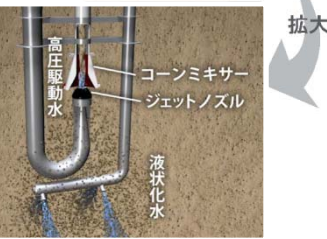
液状化水(青色)を海底面に吐き出して、堆積した土砂を緩めて舞い上げさせ、高圧駆動水(白色)と一緒にスラリー(赤色)として吸い上げます。 *スラリー: 土砂が混じった海水
