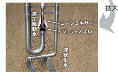
液状化水（青色）を海底面に吐き出して、堆積した土砂を緩めて舞い上げらせ、高圧駆動水（白色）と一緒にスラリー（赤色）として吸い上げます。
