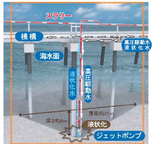
ジェットポンプの仕組み
