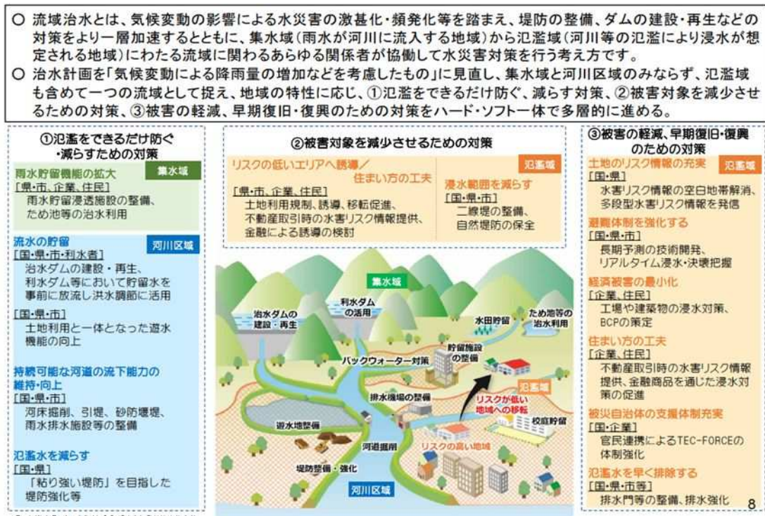
図 5.3 流域治水の「3つの方向性」の概念図
