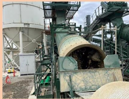
※CSG(Cemented Sand and Gravel)とは セメント、砂、砂利に水を添加して混合したもの
