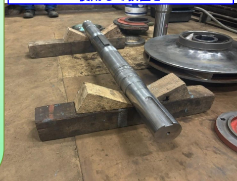
盤木にくさびを打ち込んだものを台座に使用して仮置き
