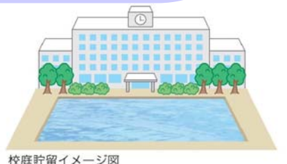
校庭貯留イメージ図 注) 時間雨量68mm(確率規模W=1/20相当)の大雨時に30cm程度、雨水を一時的に貯留します。 ※校庭貯留8校および沼原川調整池は、貯留容量が少なく、今ノ浦川の水位低下効果は小さいが、周辺の浸水被害の軽減に効果があります。
